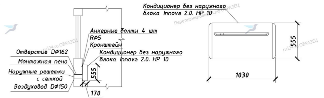
Схема крепления кондиционера к стене
